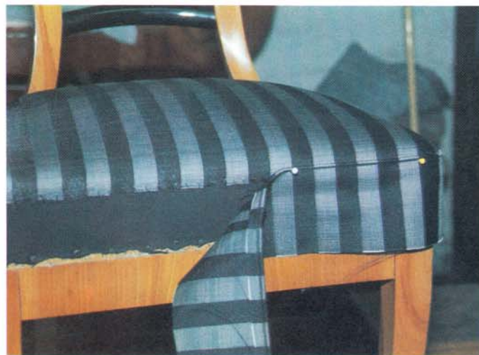
5. Anbringen des Bodens. Letzte Detailarbeiten.
